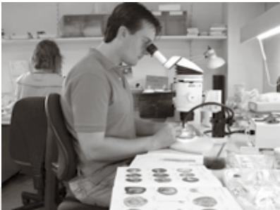
Foto: Opvallend-lichtmicroscop met vergroting tot 50x, een lichtbron met koud licht en flexibele lichtpunten, voor analyse van botanische macroresten.
